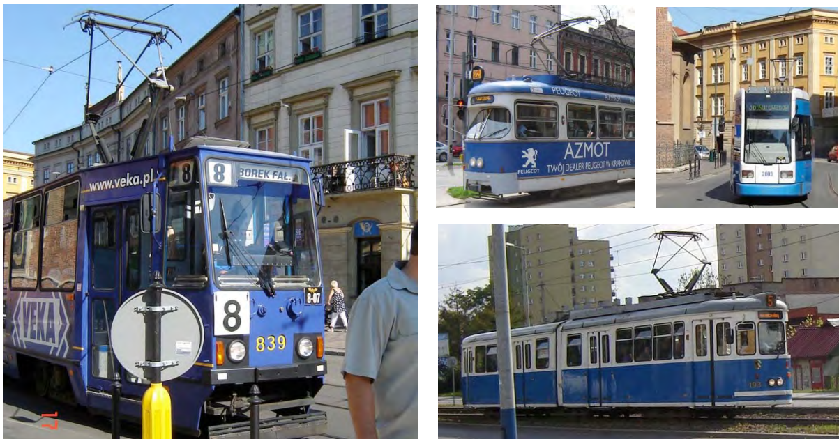
Bild 1: Straßenbahntypen "105N" (links); Düwag E1, genannt "Vienna" (oben mittig); Bombardier (oben rechts); MAN GT6, genannt "Nürnberg" (rechts unten)
